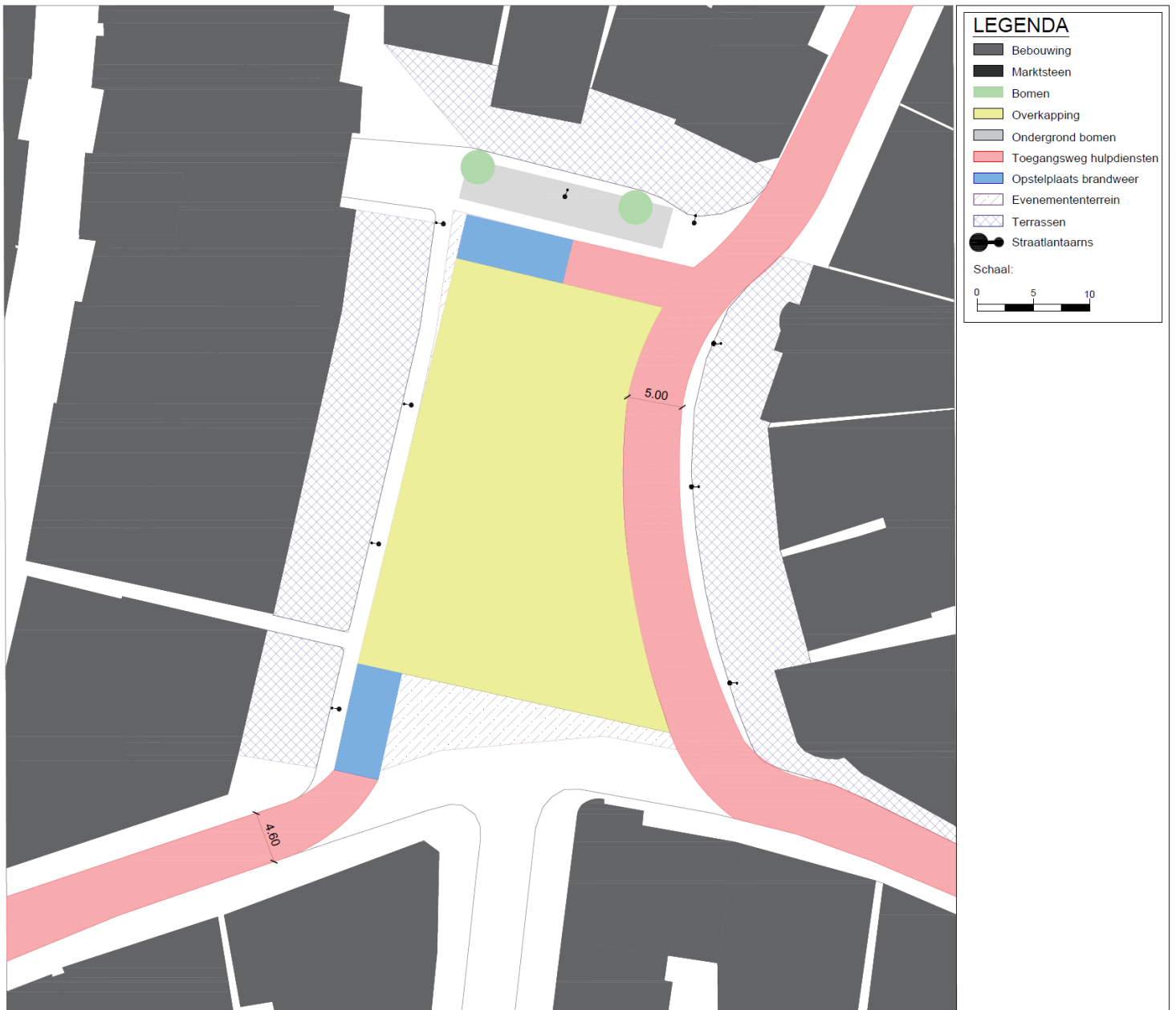
Figuur 32: Kaart van locatie van toegangswegen voor hulpdiensten in het concept Focus op Drooghouden Bezoekers
